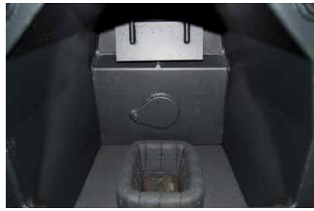
Camera di combustione
